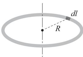
**Esempio:** Consideriamo un anello sottile di raggio  $R$  e massa  $m$ . Se  $\lambda$  rappresenta la densità lineare dell'anello, pari a:
