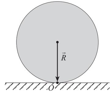
Il moto testé descritto può aversi o per l'azione sull'asse di una forza orizzontale costante o attraverso l'applicazione sull'asse di un momento costante oppure, nel caso più generale, per l'azione contemporanea sull'asse sia di una forza che di un momento.
