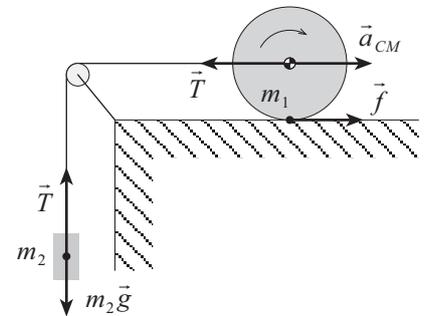
opposta a  $\vec{f}$ , allora il moto del centro di massa del cilindro sarebbe stato descritto dall'equazione  $m_1 a_{CM} = T - f$ , l'equazione del moto di rotazione del cilindro sarebbe stata  $I\alpha = Rf - \tau$  e per il corpo sospeso  $m_2 a_{CM} = m_2 g - T$ . I risultati ottenuti, ovviamente, non devono dipendere da questa scelta. Dalla terza equazione segue:
