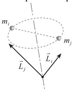
Quando il corpo presenta un asse di simmetria e la rotazione avviene attorno a tale asse, per ogni elemento del corpo il corrispondente vettore  $\vec{L}_i$  ha un vettore simmetrico  $\vec{L}_j$ , associato all'elemento diametralmente opposto a quello dato rispetto l'asse. In questo caso il vettore momento angolare del corpo è orientato lungo l'asse di rotazione e pertanto risulta parallelo a  $\vec{\omega}$ . Si può dimostrare che per ogni corpo, indipendentemente
