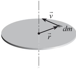
**Esempio:** Valutiamo il momento angolare di un disco sottile omogeneo che ruota nelle stesse condizioni del precedente esempio. Sia  $R$  il suo raggio ed  $m$  la sua massa. In tali condizioni, il momento angolare elementare  $dL$  dell'elemento  $dm$  del disco vale:
