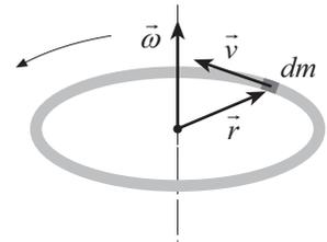
i vettori  $\vec{r}$  e  $\vec{v}$  sono perpendicolari tra loro, così  $\vec{L}$  è diretto lungo l'asse; inoltre, per ciascun elemento  $dm$  il modulo dei vettori  $\vec{r}$  e  $\vec{v}$  è costante e in particolare risulta:
