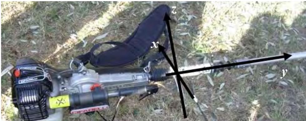
Figura 2. Sistema di riferimento basicentrico adottato per le misurazioni.
